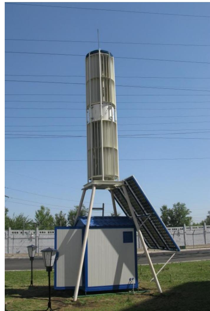
**Рис. 17 КЭС ВРТБ суммарной мощностью 2,5 кВт на площадке ТОО «Машзавод»**
