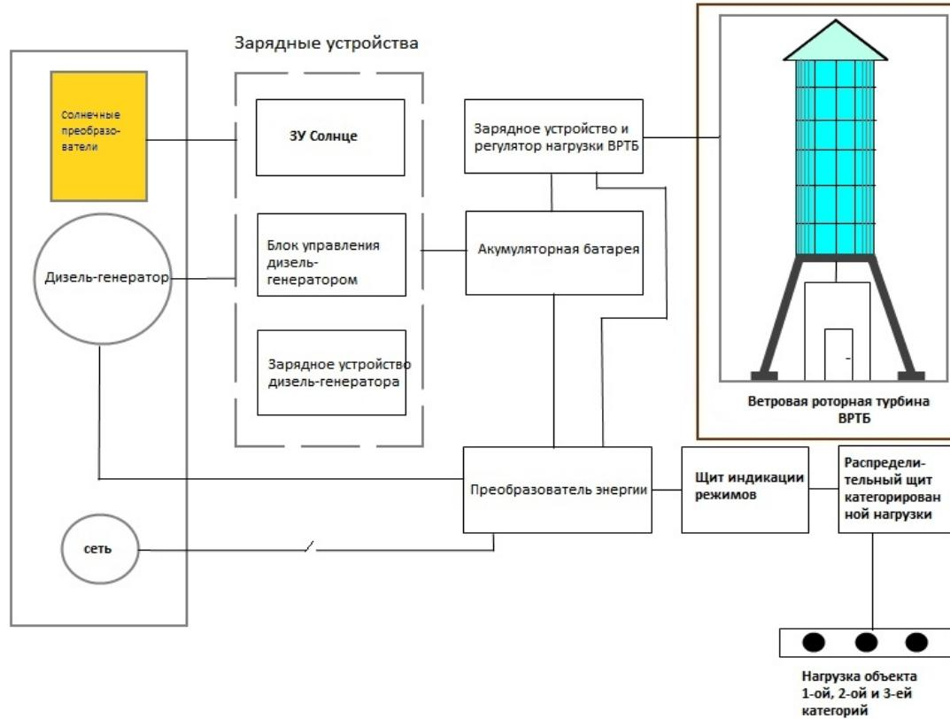
Рис.7 Комплексная энергетическая система ВРТБ содержит следующие основные компоненты
