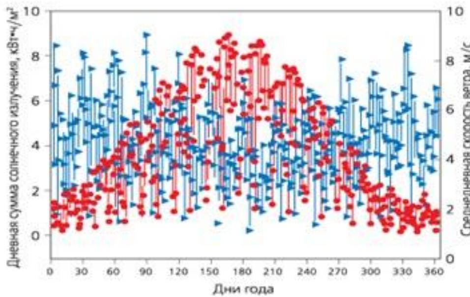
Рис 6. Синэнергетический эффект — сложение энергий, поступающих от разных возобновляемых источников энергии.
